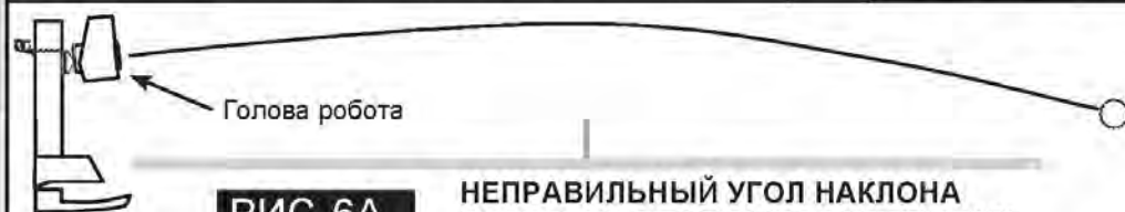
РИС. 6А НЕПРАВИЛЬНЫЙ УГОЛ НАКЛОНА ГОЛОВЫ (РОБОТ ВЫПОЛНЯЕТ УДАР)
