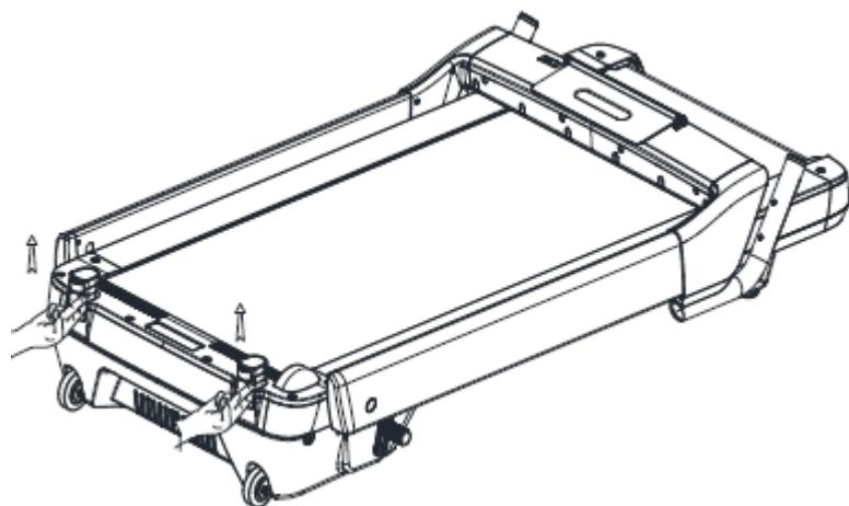
2. Затем вы можете перемещать тренажер в вертикальном либо наклоном положении. С помощью вспомогательных роликов вы можете двигать его влево и вправо, а с помощью больших роликов вперед и назад.
