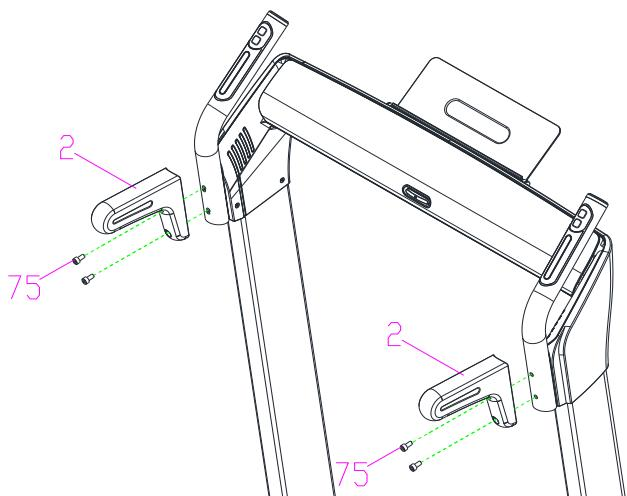
Плотно закрепите поручни (2) на кронштейне беговой дорожки с помощью винта M6 \* 12L (75).
