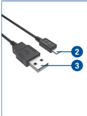
Для подключения глюкометра к компьютеру вам понадобится кабель USB с максимальной длиной 1,5 м со штекерами Micro-B (маленький штекер) и штекером USB-A (большой штекер). Штекер Micro-B **2** вставляется в гнездо USB глюкометра. Штекер USB-A **3** вставляется в порт USB компьютера.
