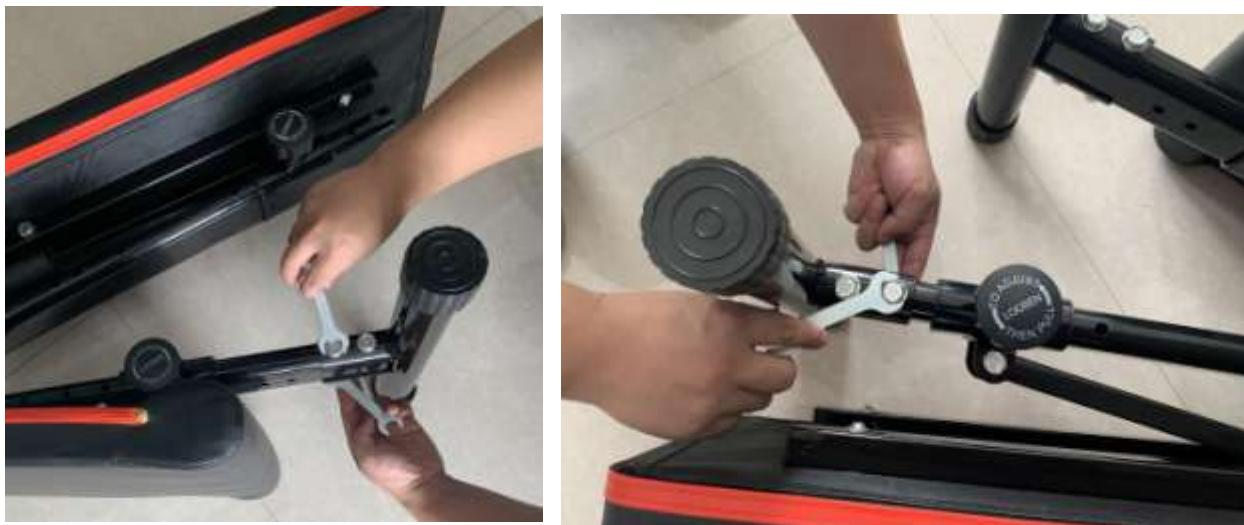
Соберите опорные трубы (№ 2) гайкой, плоской шайбой, болтом (№ 5), затяните гаечным ключом (№ 6).
