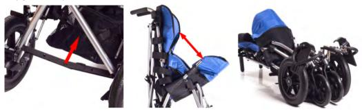
Для снятия подножек необходимо вынуть фиксаторы, а затем СНЯТЬ ПОДНОЖКИ.
