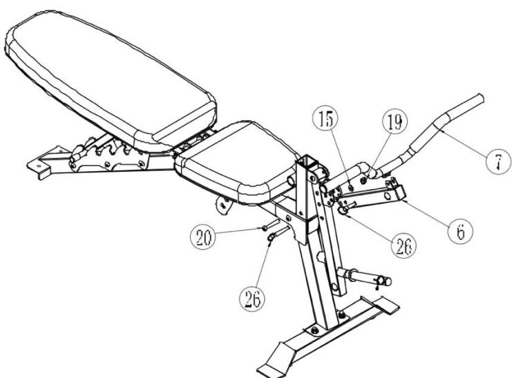
1. Установите стойку для поручня (6) на переднюю регулирующую стойку (5), а затем с помощью шестигранного болта (20), плоской шайбы (15), стопорной гайки (16), ключа (28) и шестигранного ключа (30) закрепите детали. Вставьте штифт Ø 10\*65 (26) для фиксации.
