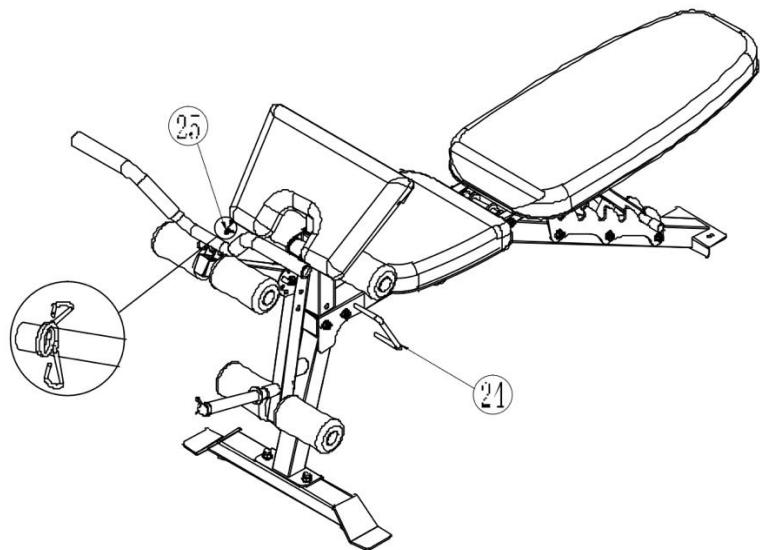
1. Вставьте стержень с крючками (24) в переднюю опору (2) и опору для ног (5), затем установите ограничительное кольцо Ø10 (25), чтобы закрепить детали.
