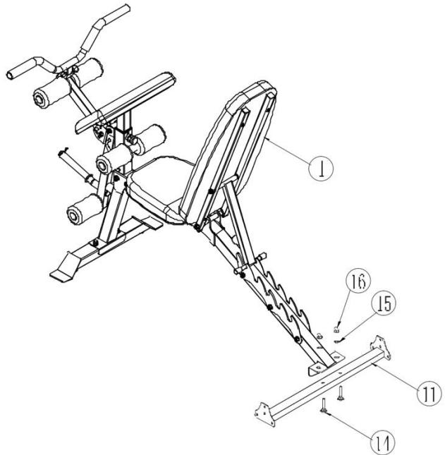
Установите задний стабилизатор (11) на основную раму и используйте два болта №14 М10х50, две плоские шайбы (15), две шестигранные гайки М10 (16), ключ с открытым концом № 15-13-17, чтобы зафиксировать детали.
