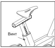
отрегулировать высоту стойку сидения, ослабьте регулировочный винт, подвиньте стойку вверх и вниз и затяните винт обратно.
