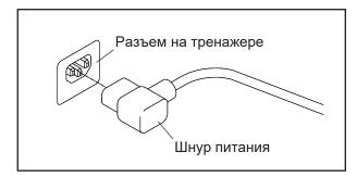
2. Воткните вилку сетевого шнура в подходящую розетку, установленную и заземлённую в соответствии с местными законами и предписаниями.
